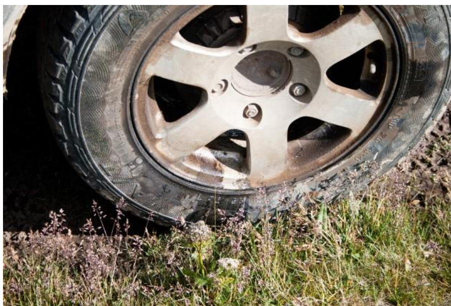
Фото № 68 Смесь воды и масла вытекающие через порванный подшипник полуоси Шевроле Нивы
